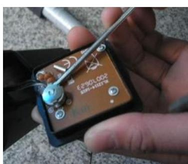
Derrière, se trouve l'unité de commande avec la pile bouton (LR44). Prélevez l'unité de commande.
