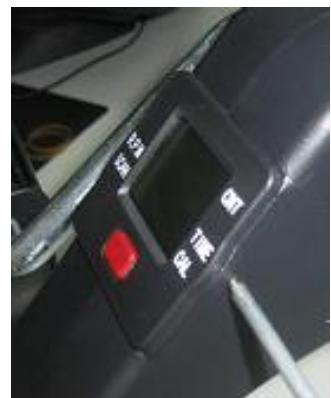
Dahinter befindet sich die Steuereinheit mit der Knopfzellen-Batterie (LR44). Entnehmen Sie die Steuereinheit.
