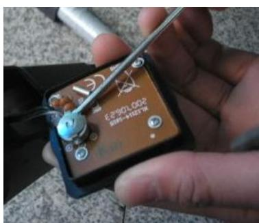
Tauschen Sie mit Hilfe eines kleinen Schraubendrehers die Batterie (LR44) und setzen sie die Steuereinheit zurück in das Gehäuse. Setzen Sie die LCD-Einheit wieder davor und drücken diese in den Rahmen, bis sie einrastet.
