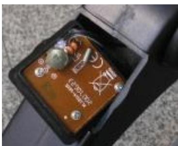
Bagved befinner styreenheden med knapcelle batteriet (LR44) sig. Fjern styreenheden.
