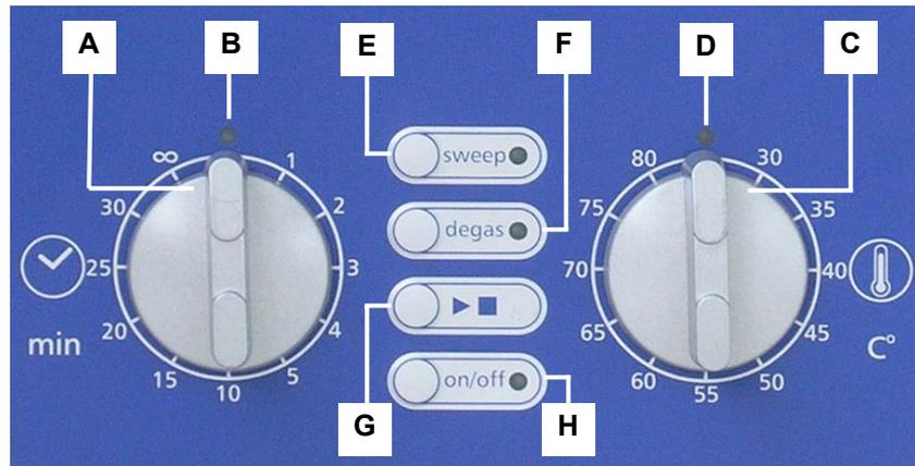
Bild 4.8 Ansicht Bedienelemente Elmasonic S 10 H
