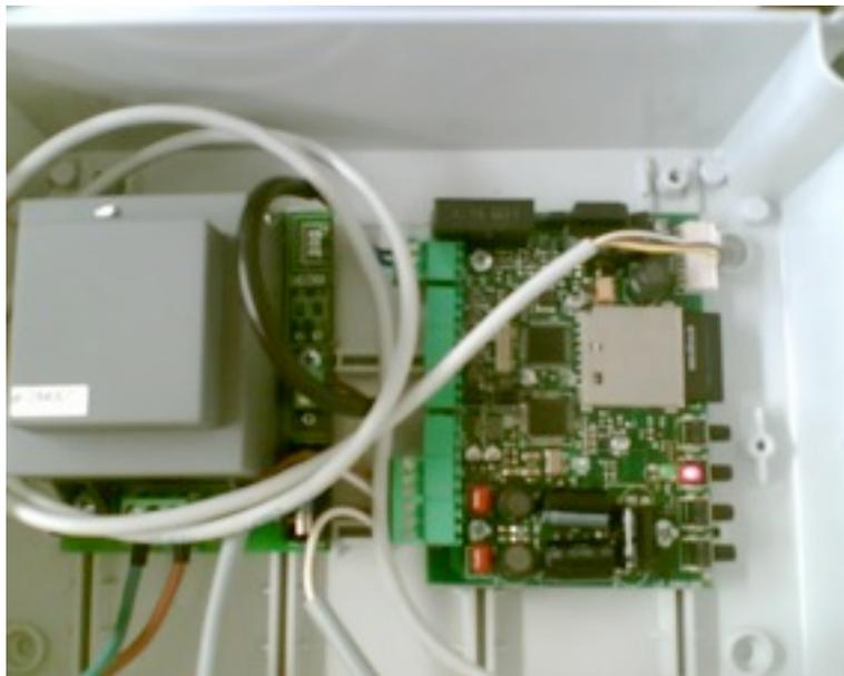
Zum bespielen der Speicherkarte, sollte die Wanne in die höchste Position gefahren werden, damit man besseren Zugang zum Steuerungskasten bekommt. Vor dem öffnen des Steuerungskastens muss die Wanne vom Stromnetz genommen werden. Nach entfernen des Deckels kann die Speicherkarte aus dem Karten-Slot (1) herausgezogen werden und mit geeigneten Medien bespielt werden (**Copyright beachten**).
