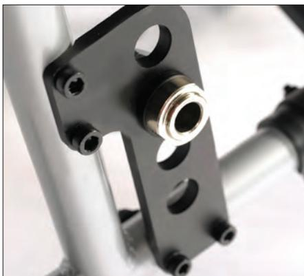
Radhalteplatte PariX. Hintere Sitzhöhe und Sitzwinkel über das Versetzen des Adapters möglich.
