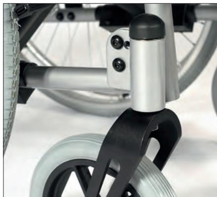
Der Winkel des Lenkrades kann entsprechend angepasst werden
