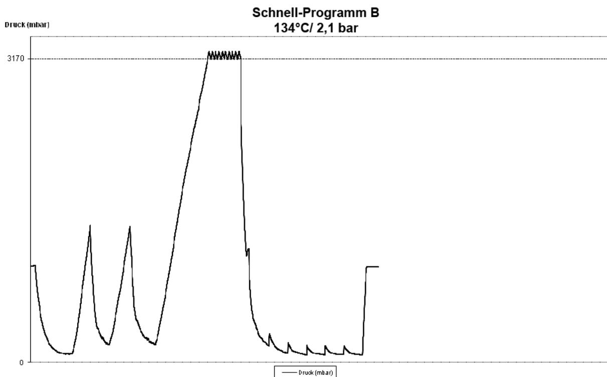
Abbildung 8: Druck-Zeit-Diagramm für Schnell-Programm B, 134°C und 2,1 bar
