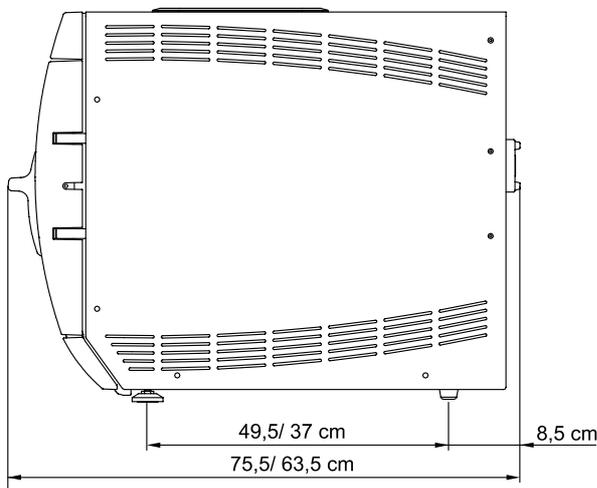
Abbildung 2: Abmessungen Vacuklav<sup>®</sup>23 B+/ Vacuklav<sup>®</sup>31 B+
