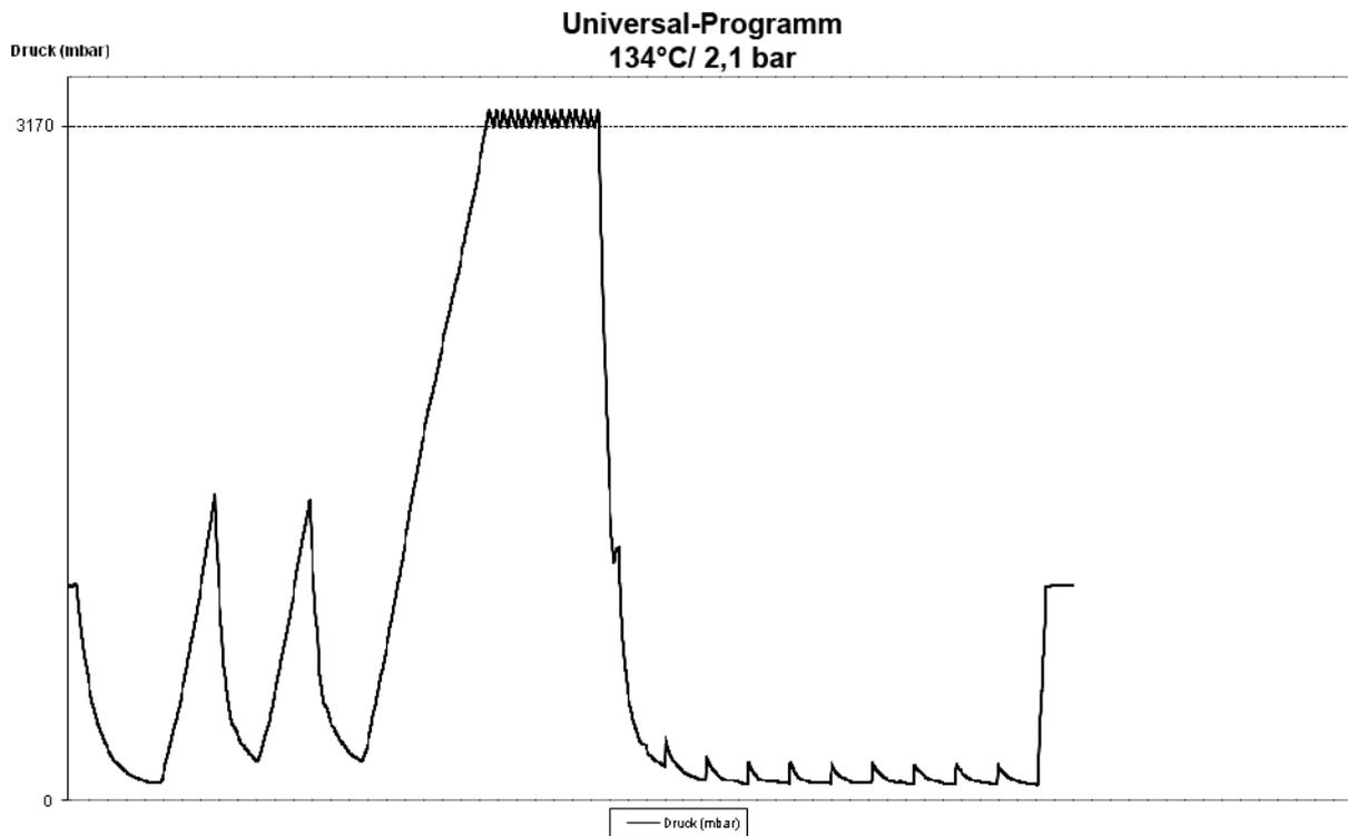
Abbildung 6: Druck-Zeit-Diagramm für Universal-Programm, 134 °C und 2,1 bar
