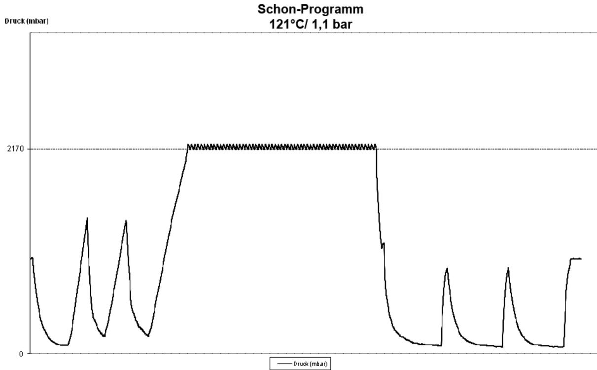
Abbildung 9: Druck-Zeit-Diagramm für Schon-Programm, 121 °C und 1,1 bar
