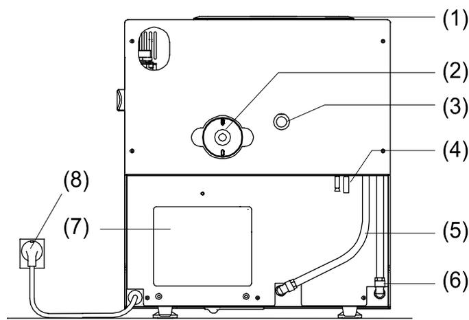
Abbildung 3: Direkte Speisewasser-Versorgung aus internem Vorratstank
