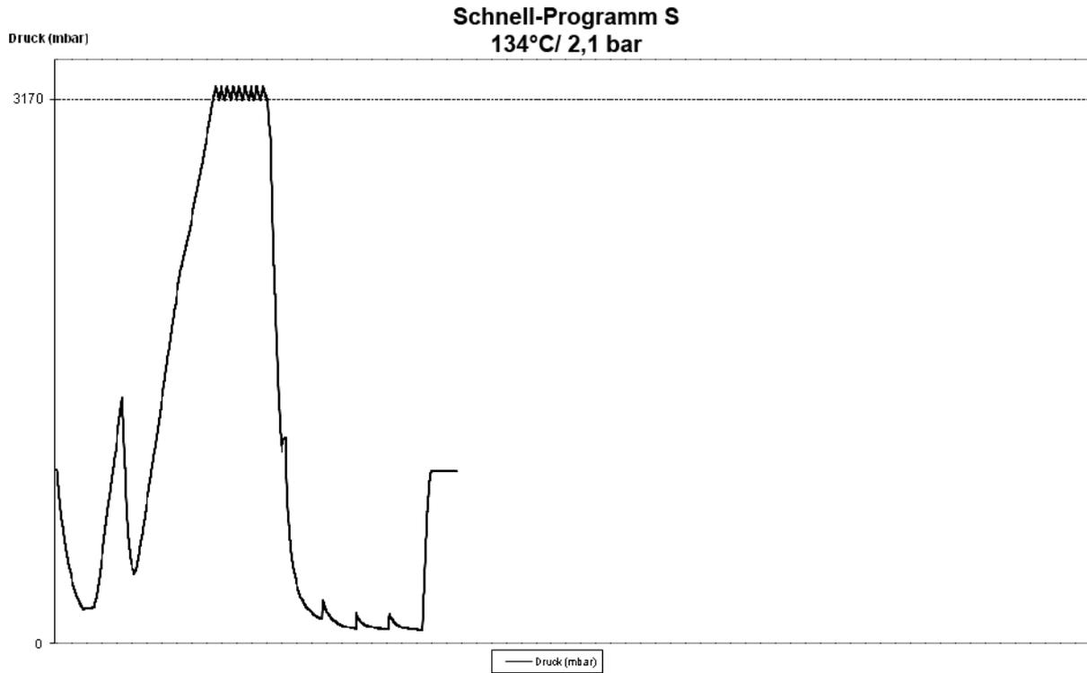
Abbildung 7: Druck-Zeit-Diagramm für Schnell-Programm S, 134 °C und 2,1 bar
