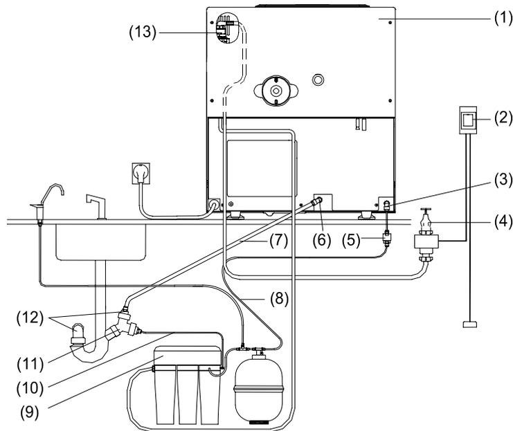
**Einspeisung des Speisewassers aus der Umkehr-Osmose-Anlage MELAdem<sup>®</sup>47**
