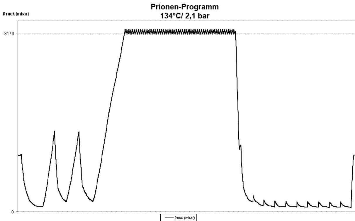
Abbildung 10: Druck-Zeit-Diagramm für Prionen-Programm, 134 °C und 2,1 bar
