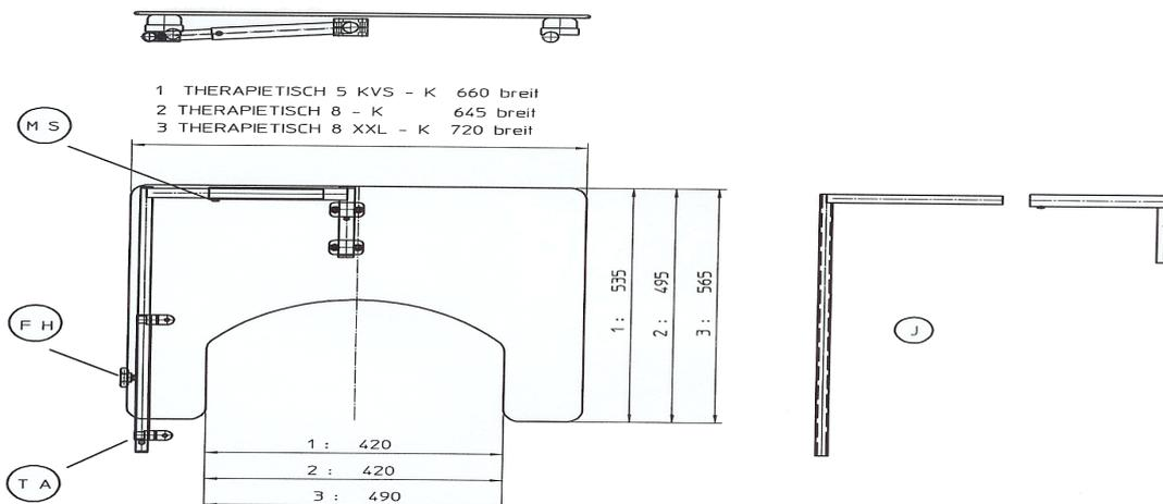
1. Montieren sie das gemäß ihren Angaben bereits vormontierte Therapietisch-Aufnehmerrohr (TA) unter der rechten oder linken Armlehne. Die Montageabfolge richtet sich nach dem entsprechenden Rollstuhl-Modell.
